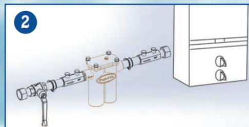
**2** Geplaatst op de koudwaterleiding van de boiler, beschermt de 150B het warmwatercircuit.
